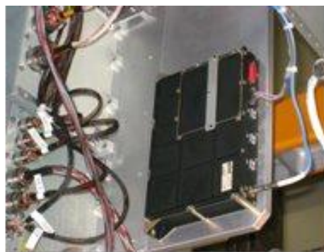
Antenne (placée au sommet du détecteur) et récepteur GPS (placé à l'intérieur de la structure) d'AMS-02
